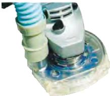
各種100mmディスクグランダに取付け、粉じんの飛散をシャットアウト
